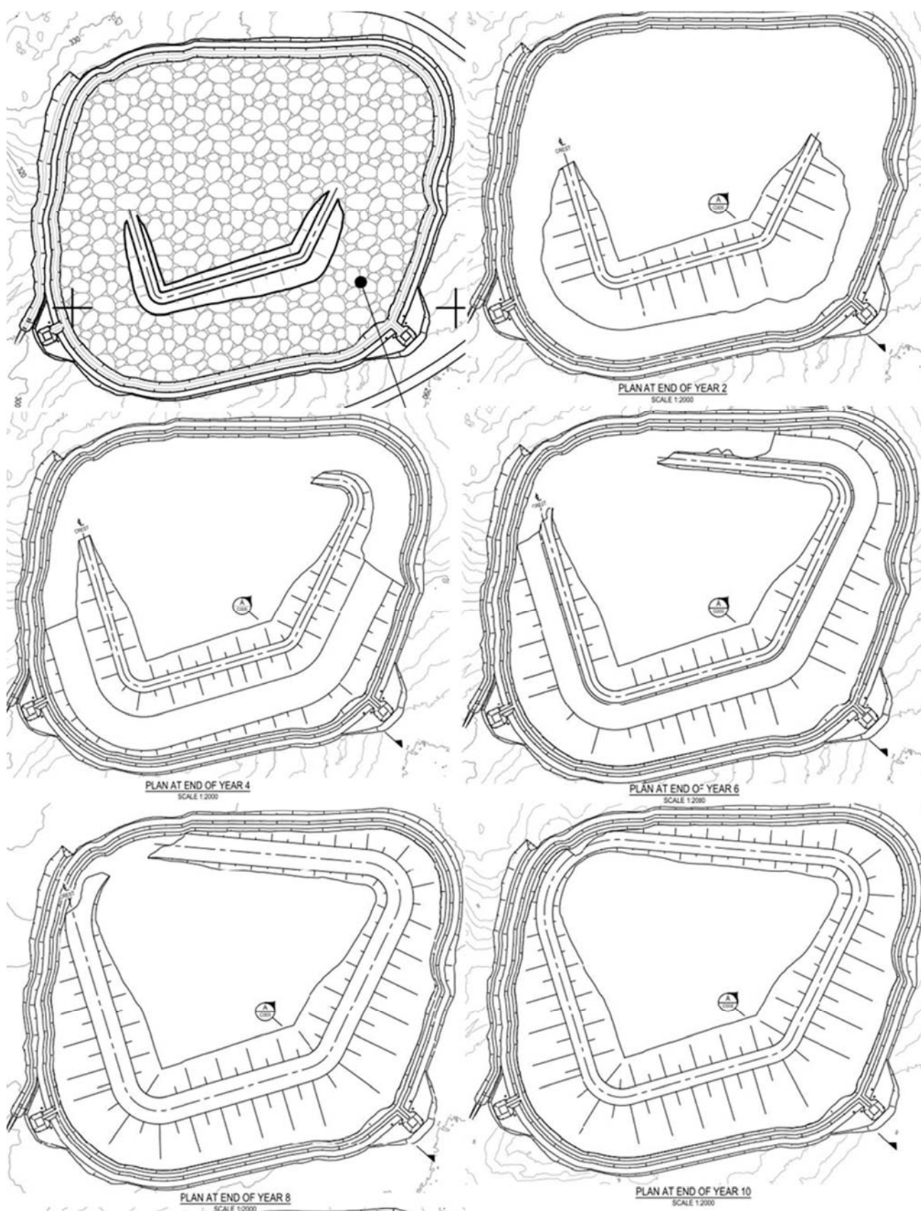
Figur 7: Uppbyggnad av sand- och gråbergsmagasinet från år 0 (uppe till vänster) till år 10.
