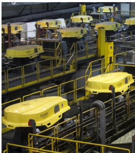
Figur 25: Industriell primär flotation, exempel på krets.
