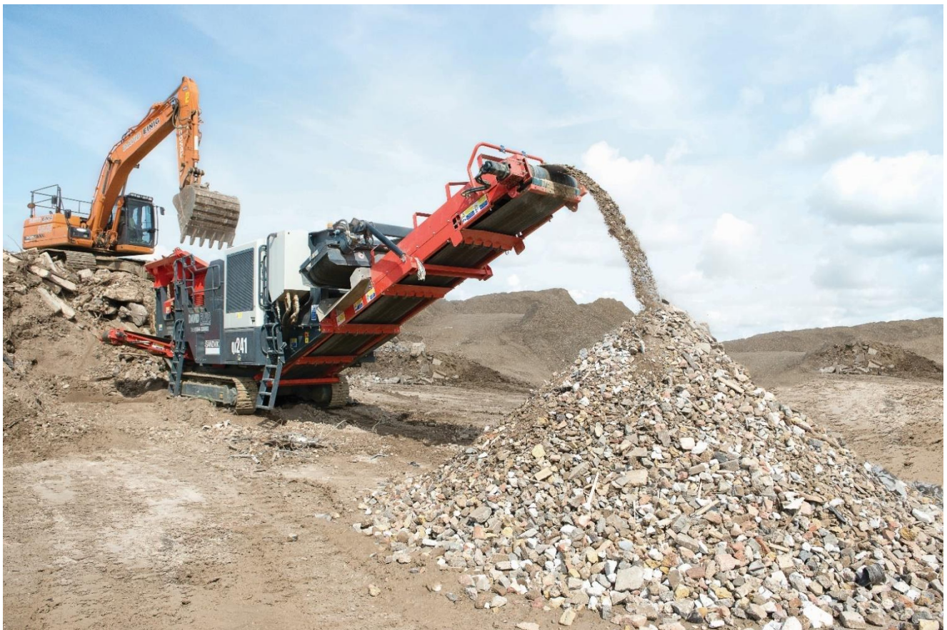
Figur 19: Exempel på primärkross.
