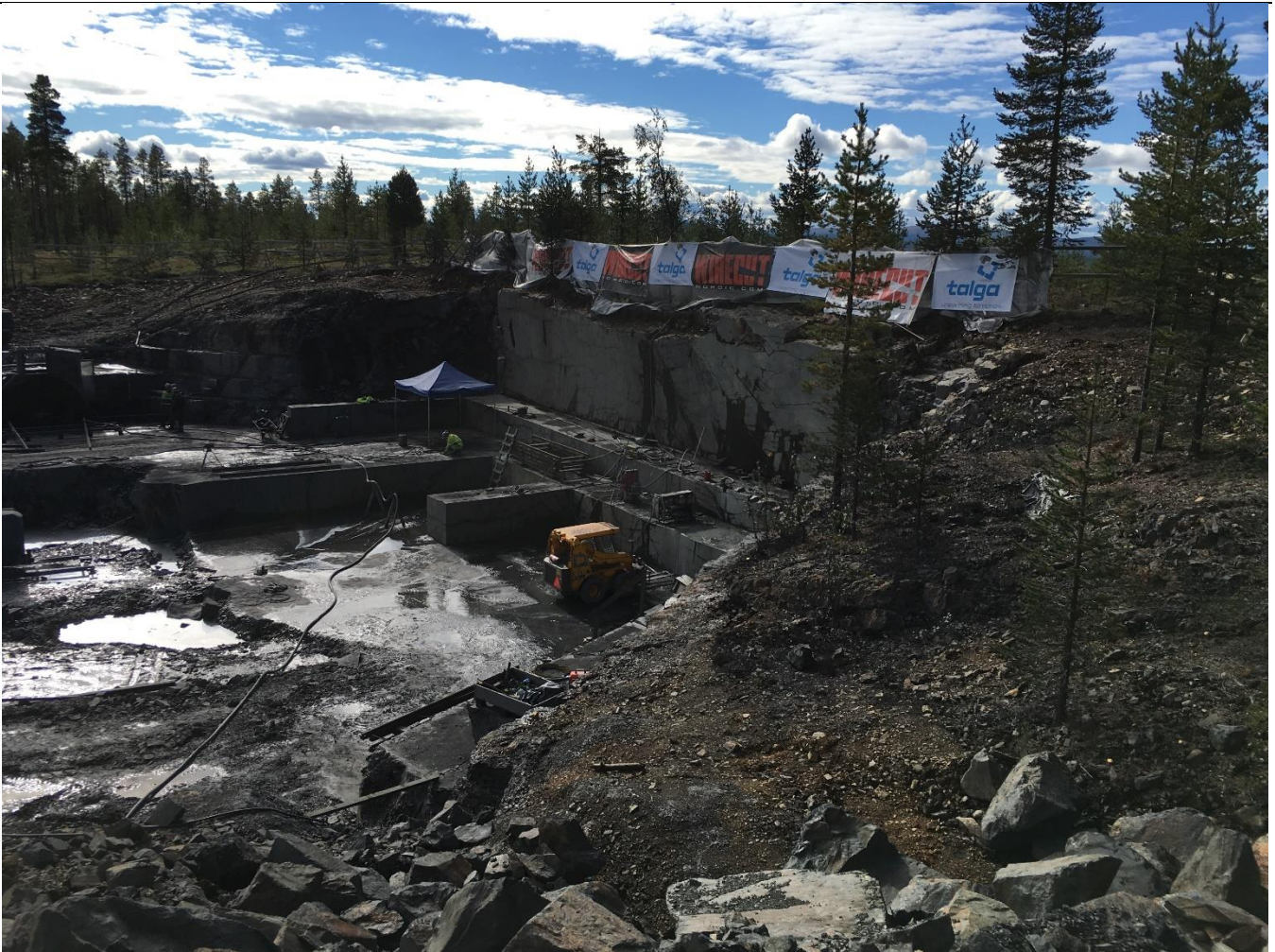
Figur 33: Blockstensbrytning utförd av Talga under provbrytningen 2016 med klingsåg och vajersågning.
