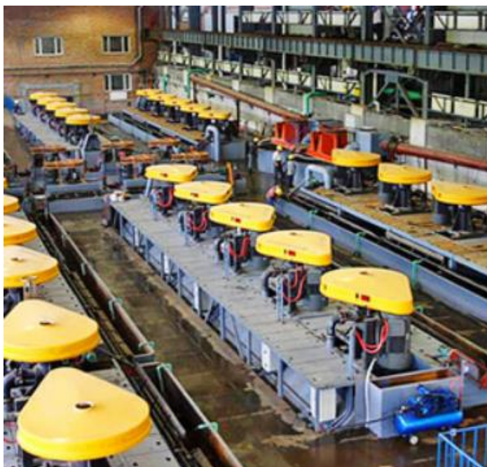
Figur 26: Exempel på banker med celler för sekundär flotation.
