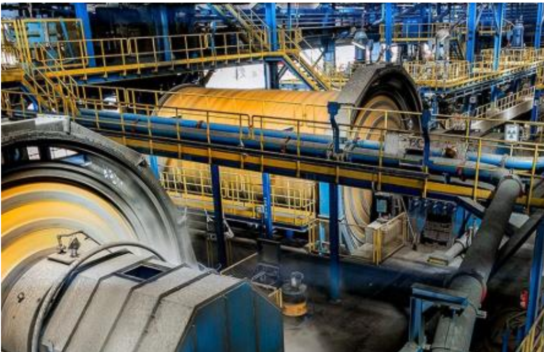
Figur 24: Exempel på kulkvarns- och cyklonkrets.
