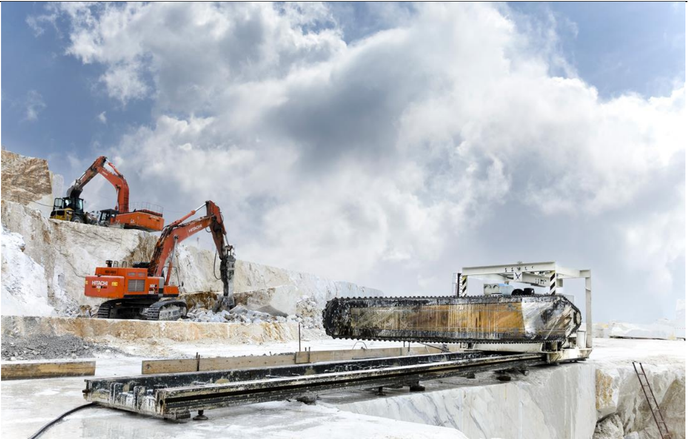
Figur 34: Exempel på utrustning, kedsåg för sten.
