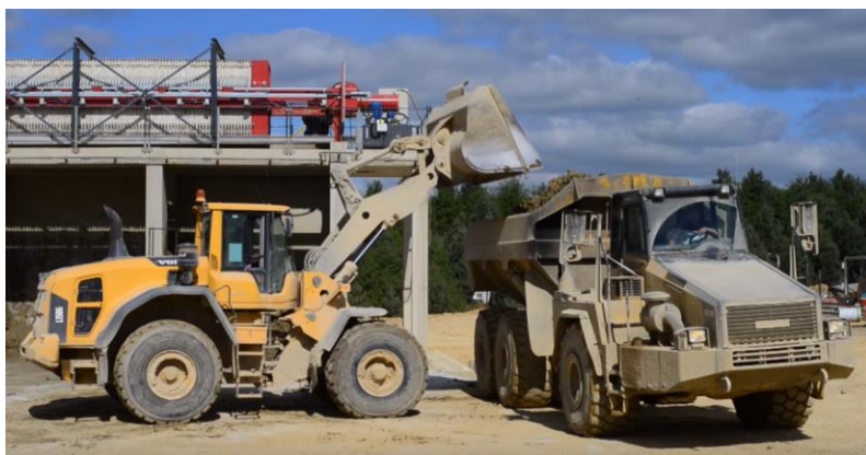
Figur 29: Exempel på lastning och transport av anrikningssand.
