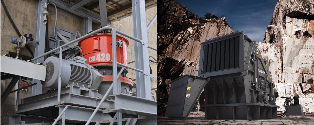
Figur 23: Exempel på konkross (vänster) och rotarycross (höger).
