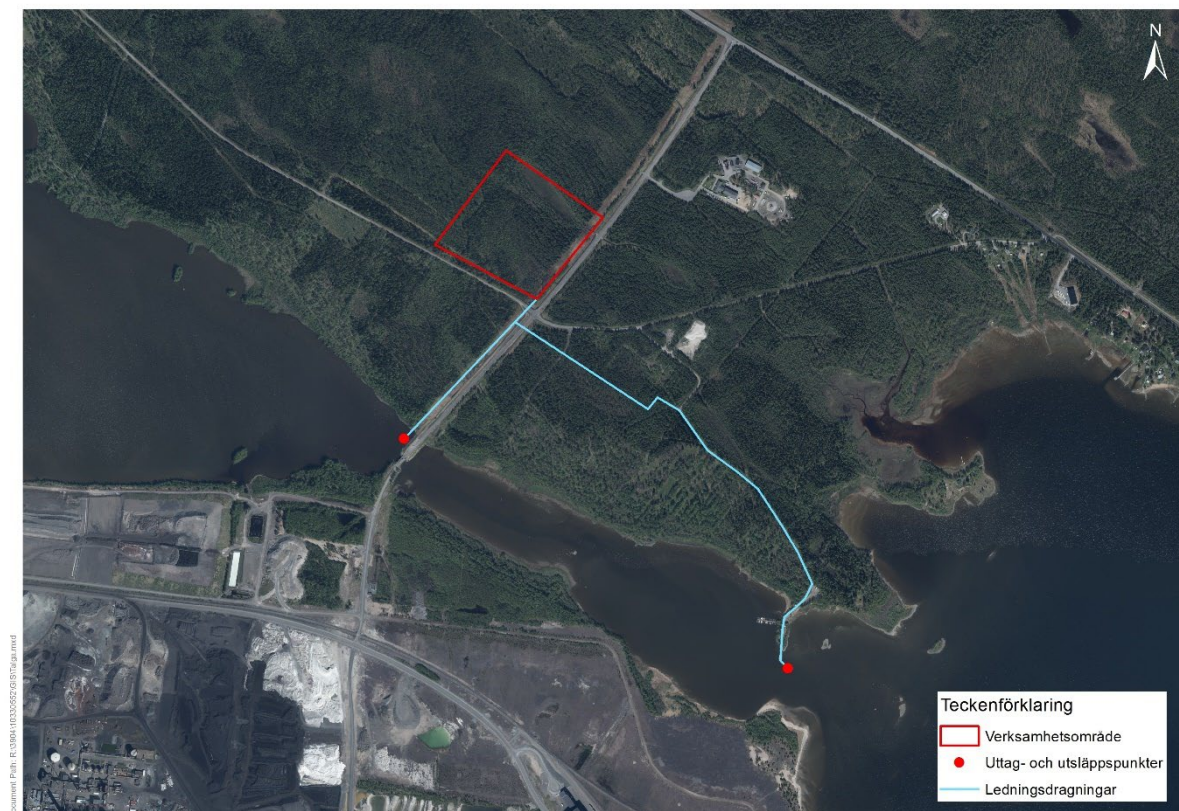
Figur 10. Ledningsdragningar och punkter för uttag och utsläpp av kyl- och processvatten i ansökt verksamhet.
