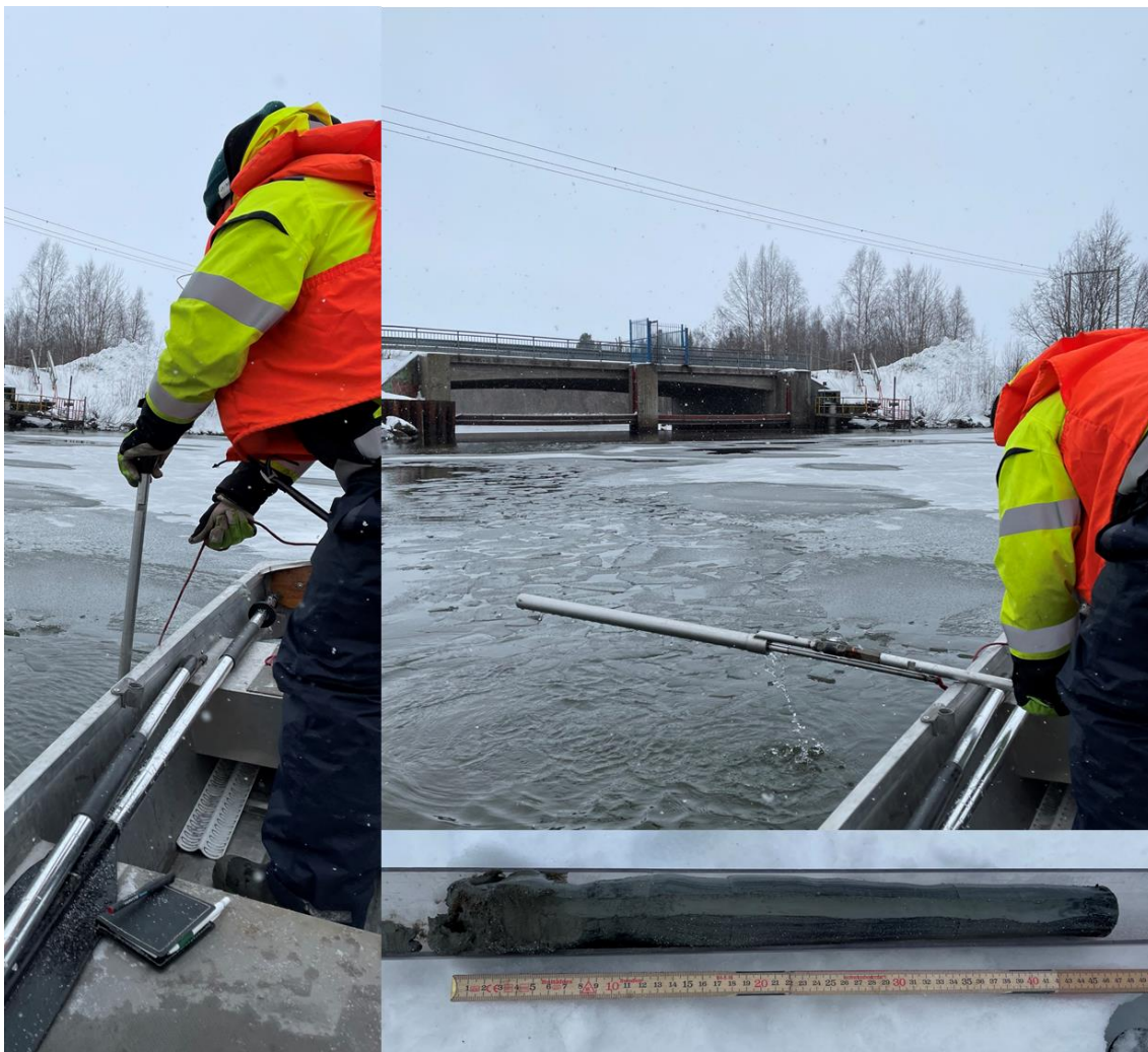
Figur 4 Sedimentprovtagning. Provtagaren trycks ner i sedimentet samtidigt som man drar upp kolven i röret genom att dra i linan (till vänster). Provtagaren lyfts upp och genom att man trycker kolven tillbaka pressar man ut kärnan.
